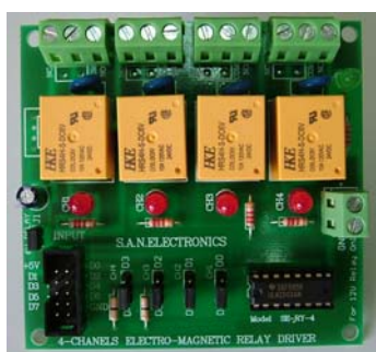
บอร์ด Electro-Magnetic Relay แบบ 4 ช่อง สำหรับทดลองการควบคุมมอเตอร์แบบ H-Bridge
